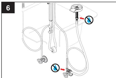
6 湯水両方の止水栓を開き、全ての接続部分で水漏れがないことを確認します。
