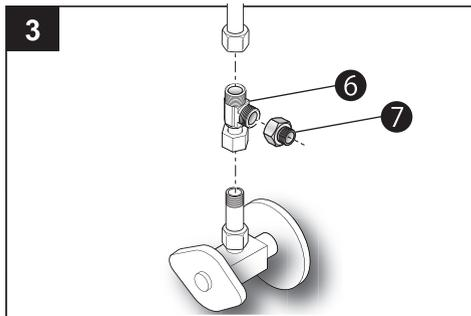
3 止水栓に接続された給水管を外し⑥片ナットフレキ用チーズと⑦13mm 変換アダプターを止水栓に取り付けます。
