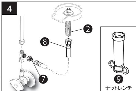
4 ⑧ホースの 13mm ナット側を⑨ナットレンチを通して②軸棒に締付けます。
