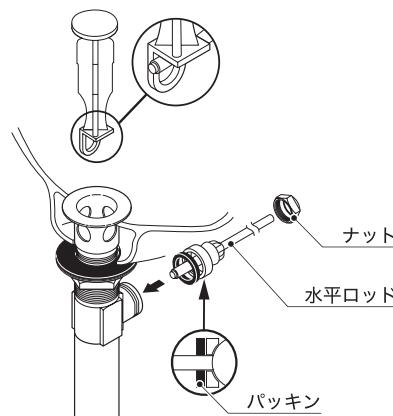
ユニットのナットを外して水平ロッドをユニットに取付けた後、ナットを手締めする。水平ロッドの先のパッキンの位置を間違えないこと。
