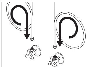
ホースの先を変換アダプターに取付け、手で軽く回す。
