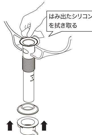
ガスケットをテールピースに通し、ナットを締付ける。
