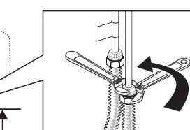
給水・給湯ホースと連結するときは上のレンチは回さず、フレキパイプのナットを回す。
