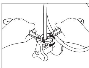
変換アダプターを押さえながら、もう一方のレンチでホースナットを回して固定する。
