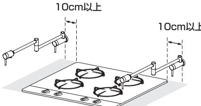
火力で水栓が高温となり火傷やパッキンが変形する恐れあります。本体はガスコンロの両端から10cm以上離して設置してください。
